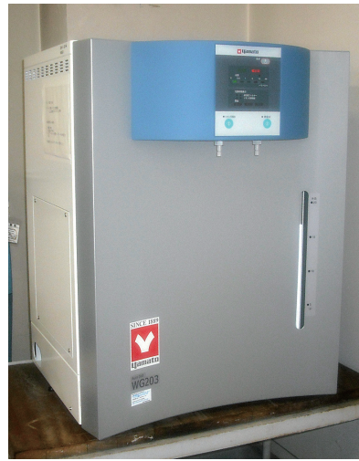
純水製造装置
